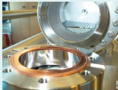
Le vide secondaire est atteint grâce à une pompe turbomoléculaire. La chauffe est pour sa part assurée par un ruban chauffant à l'extérieur de l'enceinte.
