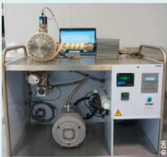
Le vide secondaire est atteint grâce à une pompe turbomoléculaire. La chauffe est pour sa part assurée par un ruban chauffant à l'extérieur de l'enceinte.
