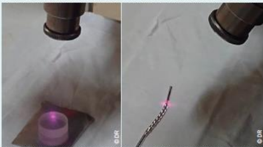
L'impulsion lumineuse transforme les premiers micromètres de la couche à éliminer en plasma fortement comprimé.
