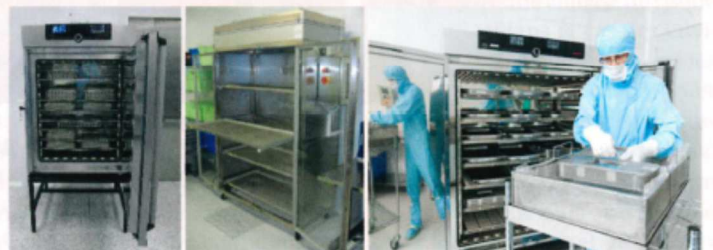
Des systèmes idoines (étuves, armoires) sont nécessaires dans le cas du nettoyage aqueux.
